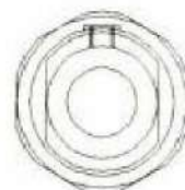
(75) WVE 防水チューブとビニルパイプの接続 亜鉛合金製/硬質塩ビ
