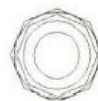
(74) BVE チューブとビニルパイプの接続 亜鉛合金製/硬質塩ビ
