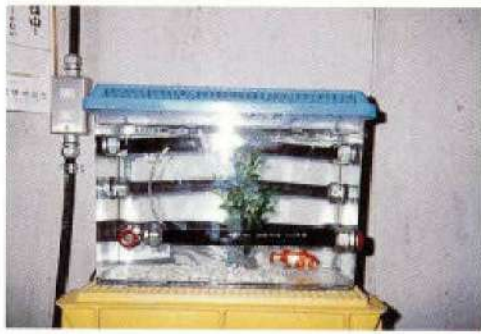
自社による簡易防水試験 市販の水槽に穴をあけ加工し中側にチューブを通し防水試験及び金魚、メダカも数年に渡り元気にしており環境にもやさしい製品です。
