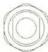
(76) WAG, WAC 防水アングロコネクター 亜鉛合金製/黄銅
